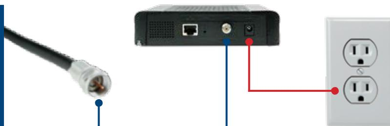
Attachez le câble au port « câble » du modem en faisant environ 3 tours dans le sens des aiguilles d'une montre ou jusqu'à ce qu'il soit solidement fixé. Sortez ensuite l'adaptateur de courant de la boîte et branchez-le dans la prise d'alimentation. Vous pouvez ensuite brancher l'autre extrémité de l'adaptateur de courant dans une prise électrique murale. **Nous vous recommandons d'attendre la date prévue d'activation pour brancher le modem.**
